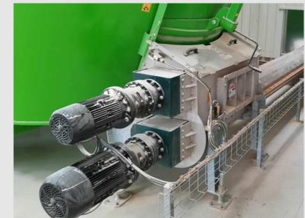
Anschluss an Vertikalmischer
