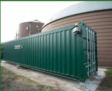
Der Vario *GO* Dosiercontainer - weltweit Plug & Play - unser Variosystem ist direkt in einem genormten 40' Open Top ISO-Container integriert. Einfacher und kostengünstiger Transport
