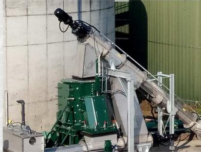
Schrägförderschnecke mit Bypass
